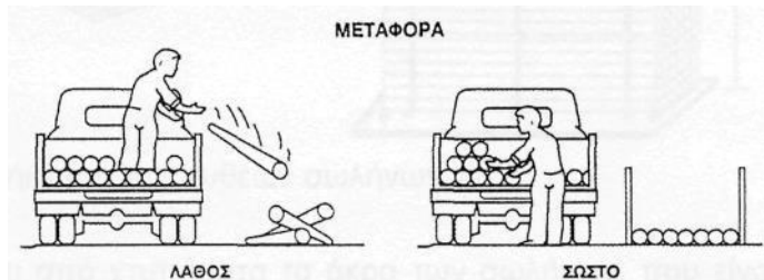
Σχήμα 5: Ανορθόδοξος και σωστός τρόπος φορτοεκφόρτωσης σωλήνων.
